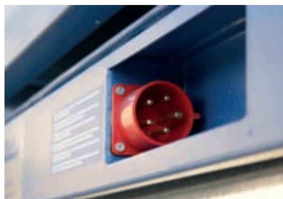
Утопленные в раме розетки CEE
